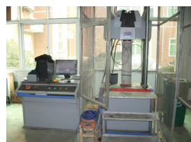
(b) 万能试验机测试光纤 压缩试验
